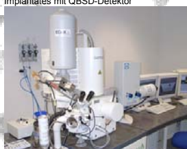
Bild 3: FE-REM LEO 1530 VP mit verschiedenen Detektoren
