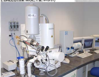
Bild 3: FE-REM LEO 1530 VP mit SE-, InLens- und QBSD-Detektor in Verbindung mit Kathodolumineszenz und Kryotransfereinheit
