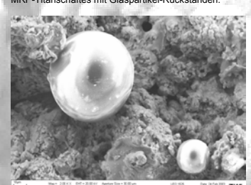
Bild 12: FE-REM SE-Aufnahme: Glasperlen in der raugestrahlten Oberfläche eines Implantates.
