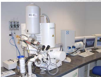
Bild 1: FE-REM LEO 1530 VP mit SE-, InLens- und QBSD-Detektor in Verbindung mit Kathodolumineszenz und Kryotransferreinheit
