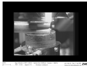
Bild 5: IR-Aufnahme einer Klinkerprobe in der FE-REM-Probenkammer. Probe auf dem Kühltisch aufgebracht, darüber das Spiegelsystem der MonoCl3 und der Antikontaminator der Kryotransferreinheit.
